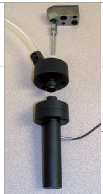
Tête de sertissage de l'écrou par le haut
