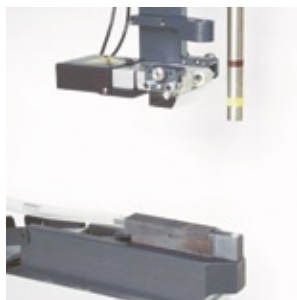
Système d'alimentation automatique des écrous par le bas
