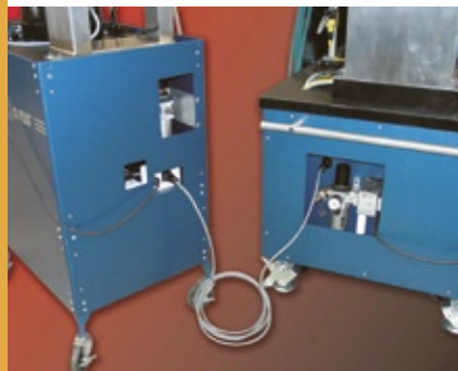
Pour augmenter la capacité d'alimentation d'inserts, il est possible de connecter un module In-die Plus (auxiliaire) au maître.
